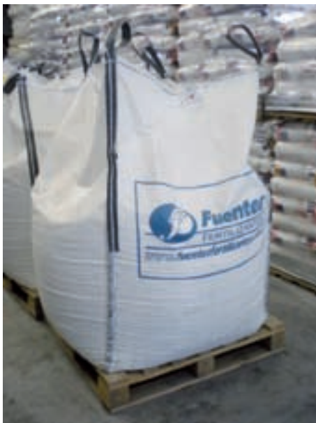
Bolsa contenedora de 1.000 kilos (Big-Bag) para fertilizantes sólidos.
