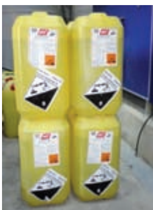
Jerricanes plásticos (garrafas) con ácido nítrico y señalización de peligro por corrosivo-abrasivo.
