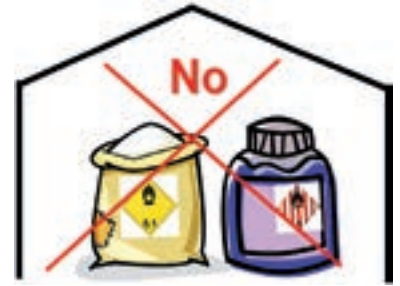
No almacenar juntos productos incompatibles.
