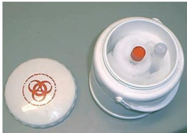
**Figura 2. Envases primarios, material absorbente y envase secundario (termo). Cortesía de Dangerous Goods Packaging,S.L**
