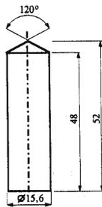
Fig.2: Pistón cilíndrico de bronce, dimensiones en mm.
