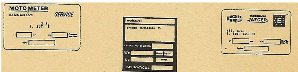
Después de la verificación al realizarse la primera instalación, deberá colocarse una placa de instalación bien visible en el vehículo, cerca del aparato o sobre el mismo. Después de cada nueva intervención del instalador o del taller autorizado, si fuere necesaria una modificación del ajuste de la instalación, se colocará una nueva placa en sustitución de la anterior.
