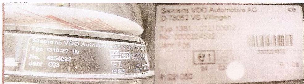
La placa descriptiva irá acoplada en el interior del tacógrafo, debidamente precintada, y en ellas deberá figurar y ser visibles:
