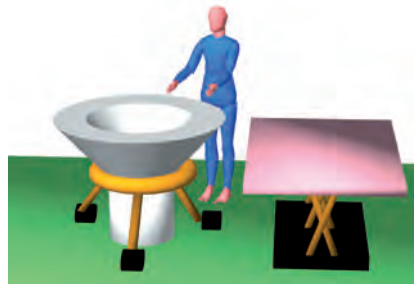
Figura 50 – Soporte elevado con ruedas para evitar el vaciado a ras de suelo
