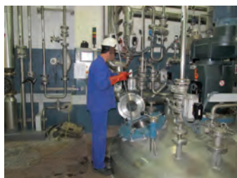
Figura 92 – Mango alargado para la recogida de muestras
