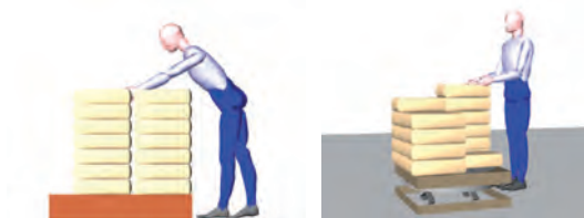
Figura 60 – Para evitar los alcances alejados en los palets, una solución puede ser colocar el palet en plataformas giratorias.
