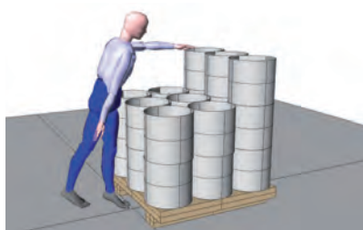
Figura 101 – Plataforma giratoria para facilitar los alcances
