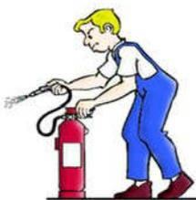
Presionar la palanca de la cabeza del extintor y en caso de que exista apretar la palanca de la boquilla realizando una pequeña descarga de comprobación.
