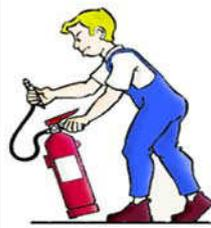
Abrir la boquilla de la manguera del extintor y comprobar, en caso que exista, que la válvula o disco de seguridad está en posición sin riesgo para el usuario. Sacar el pasador de seguridad tirando de la anilla. Asir la boquilla de la manguera del extintor.
