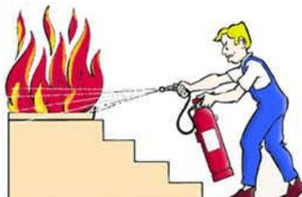
Dirigir el chorro a la base de las llamas con movimiento de barrido. En caso de incendio de líquido, proyectar superficialmente el agente extintor efectuando un barrido, evitando que la propia presión de impulsión provoque derrame del líquido incendiado. Aproximarse lentamente al fuego hasta máximo 1 m.
