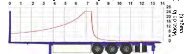
Fig.3. Ejemplo de diagrama de distribución de masas – semiremolque.
