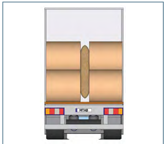
Fig. 15. Cojín hinchable en un vehículo tipo caja.
