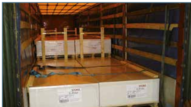
Fig. 19. Bloqueo por paneles de hojas de papel sobre palés.
