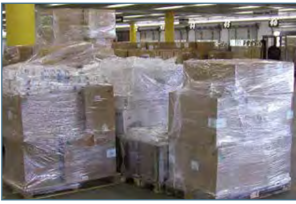
Fig. 52. Embalaje con película extensible.
