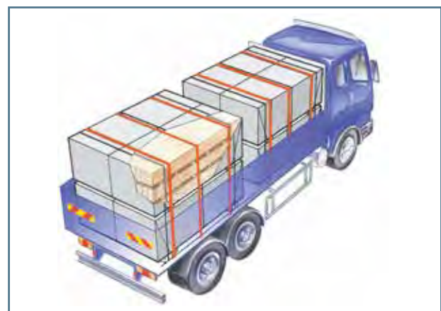
Fig. 51. Carga completa de tablones fijada.
