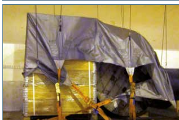
Fig. 42. Sistemas de retención con correas integradas.
