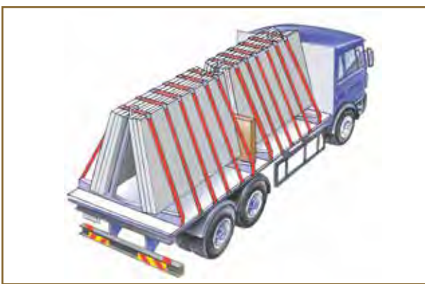
Fig. 63. Paneles sujetos a una plataforma con el dispositivo de bloqueo ya colocado.
