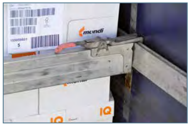
Fig. 44. Barras de bloqueo intermedio.
