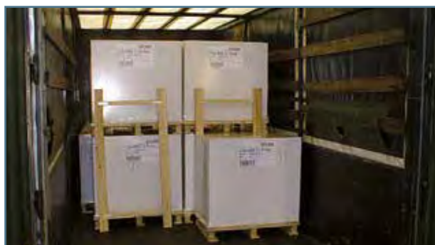
Fig. 18. Bloqueo por paneles hacia delante en segundo piso.
