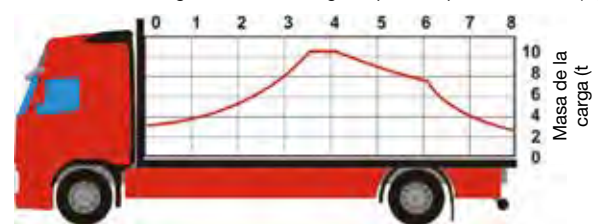
Fig. 2. Ejemplo de diagrama de distribución de masas – vehículo motorizado de dos ejes.
