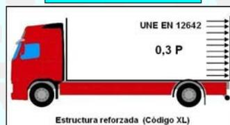
**P = el peso (en daN) del vehículo sometido al ensayo con la carga útil autorizada (5.2.1.1 UNE EN 12642)**
