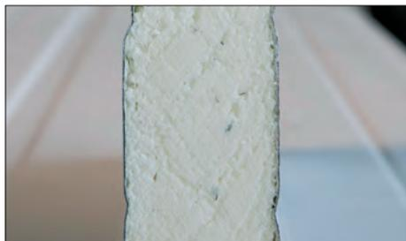
Paneles de poliuretano utilizados como aislante de paredes (Clase de material B)
