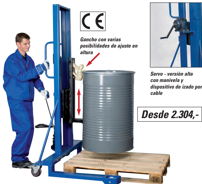
Servo FL 16-M F con unidad de traslación más ancha. Versión alta con bomba hidráulica de pedal
