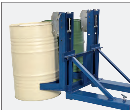
Pinza tipo SH 2 para 2 bidones de 200 litros, capacidad de carga: 2x350 Kg, peso: 96 kg, Nº ref. 115-225-13
