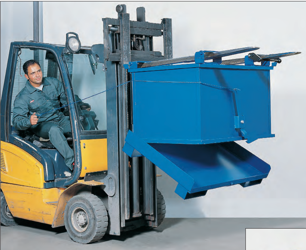
Ejemplo de uso: Fácil apertura mediante sirga accionada desde la cabina
