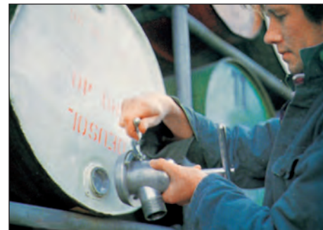
La herramienta se engancha en la tapa
