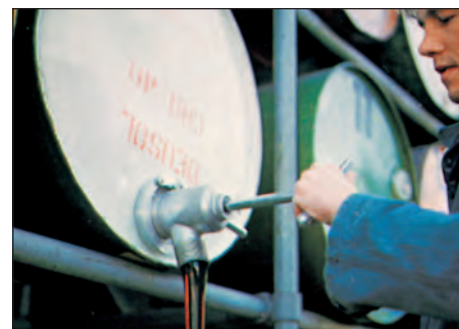
Al girar el mango, la boca se abre y se tira del tapón hacia afuera. De esta manera se permite la salida del líquido
