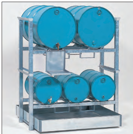
Estantería tipo AWS 3 para 2 bidones de 200 l y 3 bidones de 60 l con portajarras incluido. Capacidad de retención de 200 l, Nº ref. 114-301-13, € 838,-
