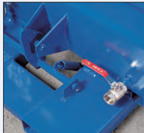
Detalle: Grifo de descarga
