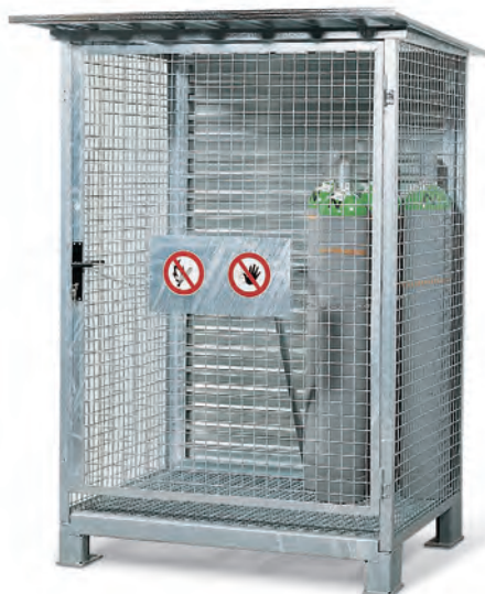
Armario tipo GS 305 sin entarimado en el suelo. El armario se puede cerrar, aunque el palet para botellas esté en posición abierta, debido a una distancia libre de 140 mm hasta la puerta
