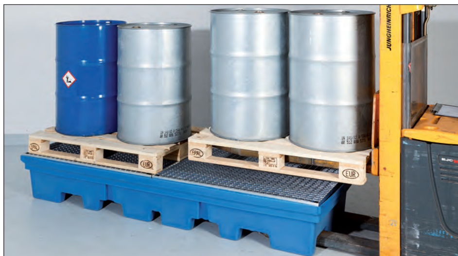
Cubeto de retención PolySafe tipo PSP 2.4 en color azul y con rejilla galvanizada para 4 bidones de 200 l, Nº ref. 134-862-13
